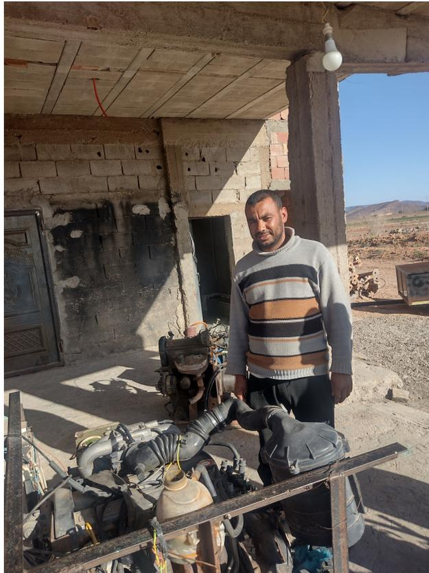
Figure 29 : Abdallah devant un moteur Ford qu'il a converti en motopompe à gaz. T. Kuper, avril 2022
