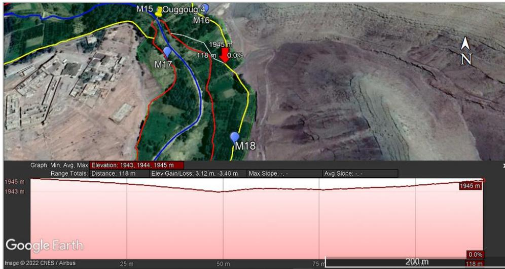
Figure 28 : Profil en travers entre séguia principale et séguia en terre
