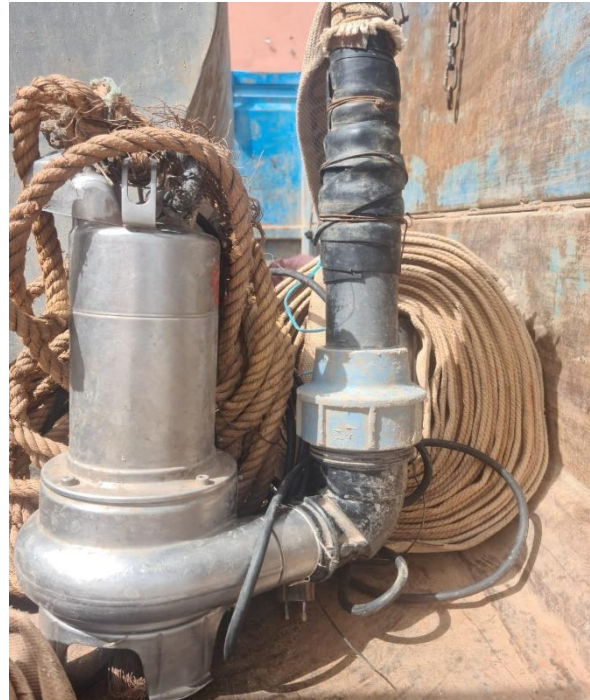
Figure 84 : Pompe pour la vidange des puits perdus de la commune Ait Youle
