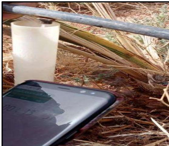
Figure 11 : Mesure des débits de goutteurs
