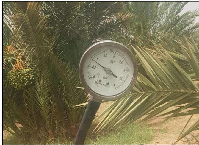
Figure 13 : Manomètre à huile utilisé pour la mesure de la pression
