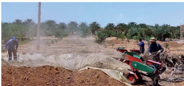
Opération de broyage des palmes sèches et mise du broyat dans un bassin d'eau (à gauche); et illustration du broyeur de palmes sèches fabriqué dans la région de Errachidia (à droite)
