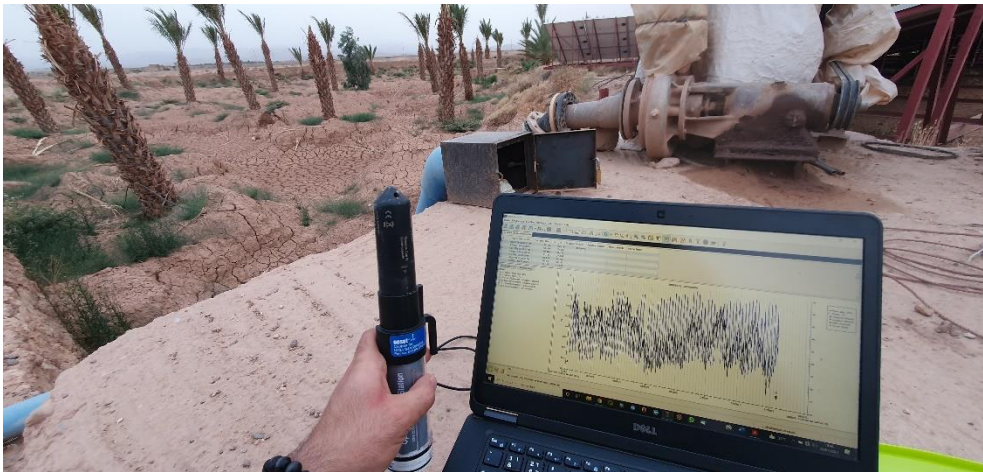
Photo de l'opération de récupération des données de la sonde installée dans le bassin de captage des eaux de crues
