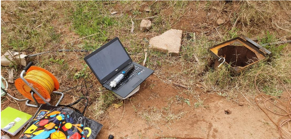
Photo de l'opération de récupération des données d'une sonde installée dans un forage
