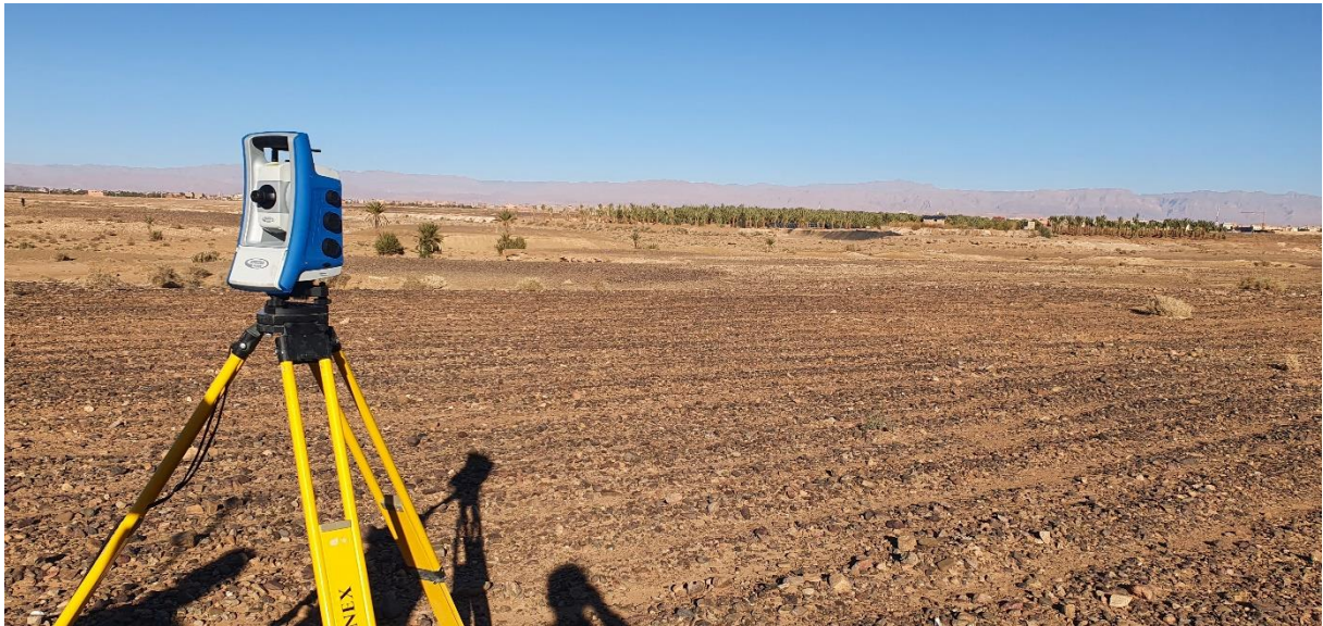
Photo du levé topographique des points de mesure piézométrique
